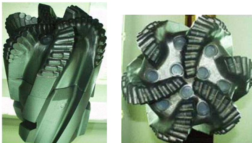
Figura 4.3. Tipo de broca utilizada para perfurar o poço PUC-1.
